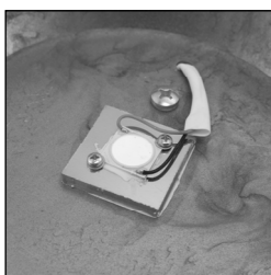
Kraftig COB LED diode i toppen af armaturhus
